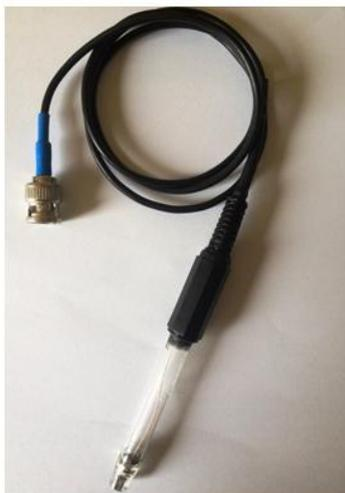
Рис. 2. Изготовленный медный электрод
